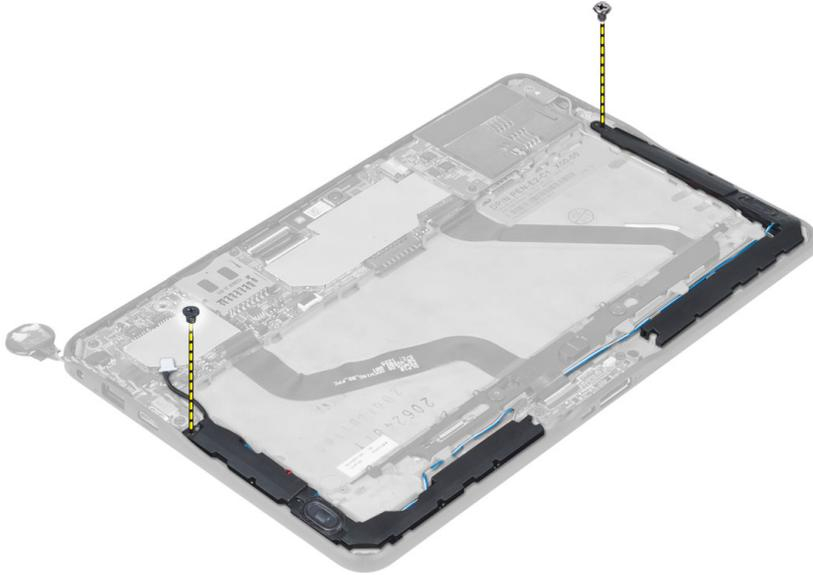
5. Retire los cables del altavoz del lado del equipo para levantar y liberar el altavoz del equipo.
